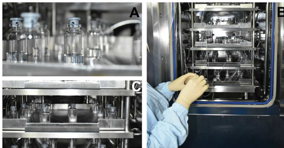
Figura 26. Proceso de liofilización de suero antiofídico. (A) Suero antiofídico antes del proceso de liofilización. (B) Suero antiofídico en cámara de liofilización. (C) Suero antiofídico liofilizado.
